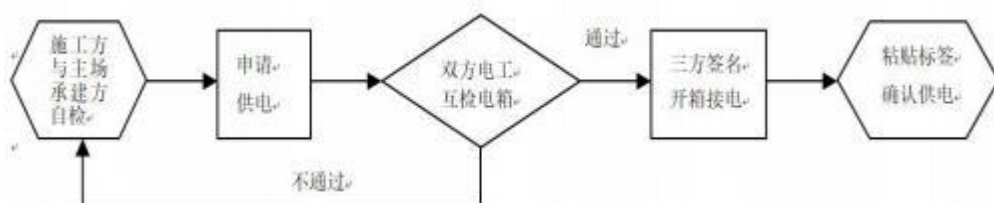
配电箱供电流程
